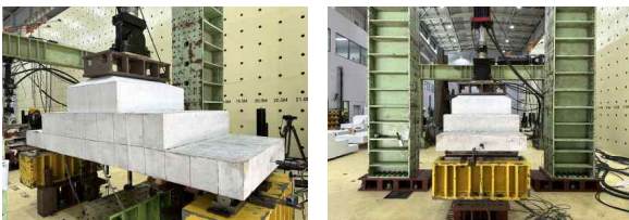
[그림 5] 연속슬래브 중력하중 정적내력 실험체 세팅안
